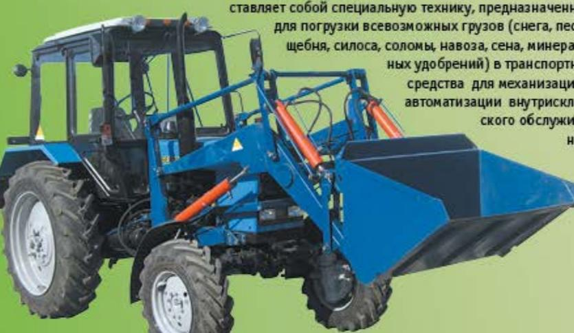
Универсальный фронтальный погрузчик ПКУ-0,8 представляет собой специальную технику, предназначенную для погрузки всевозможных грузов (снега, песка, щебня, силюса, соломы, навоза, сена, минеральных удобрений) в транспортные средства для механизации и автоматизации внутрискладского обслуживания.
