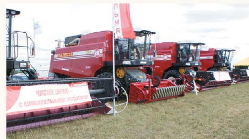
ющим пропускную способность по хлебной массе 10 кс/с, что оптимально для хозяйств с урожайностью до 30-40 ц/га. Комбайн можно оснастить жатками 6 или 7 метров с транспортной тележкой и подборщиком с шириной захвата 3,4 м.
